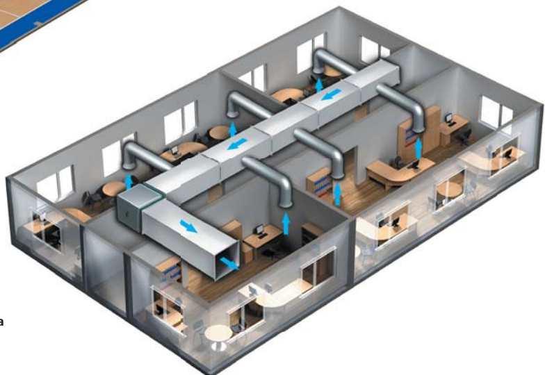
Вариант применения вентилятора ВШ в офисном помещении.
